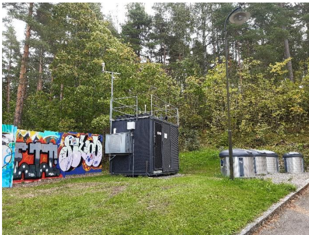
Kuva 22. Ilmanlaadun mittausasema Lohjalla, Harjulan toimintakeskuksen piha-alueella.
