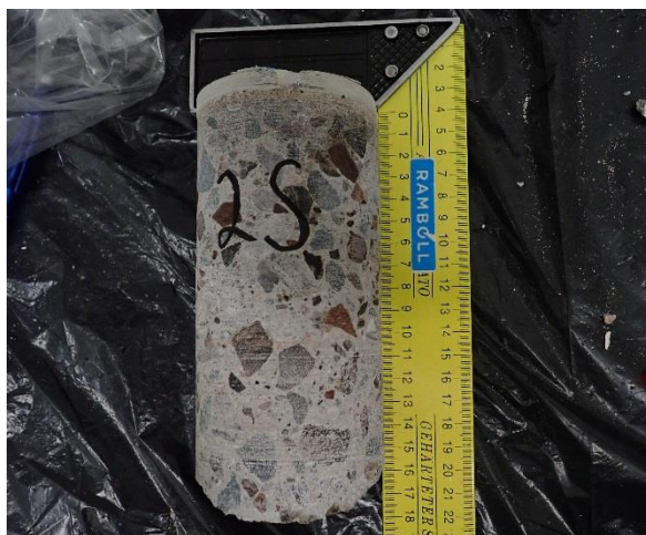
Kuva 3.16 Näyte KU-2S altaan sisäseinästä, ei vedeneristetty
