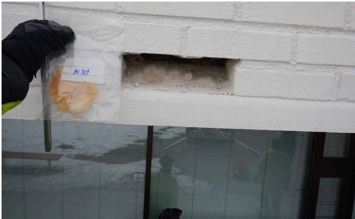
Kuva 34. Näytteet N26, N30 ja N36 otettiin leukapalkin päältä.
