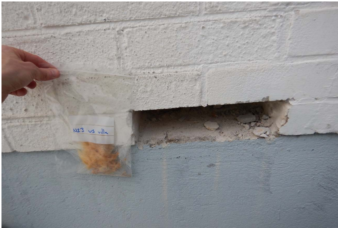
Kuva 32. Näytteet N23, N31, N32 ja N35 otettiin seinien alaosaista.
