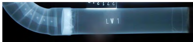
LV1: Kuvatulta putkiosuudelta ei havaittu syöpymiä.
