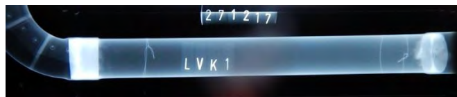
LVK1: Kuvatulta putkiosuudelta ei havaittu syöpymiä.
