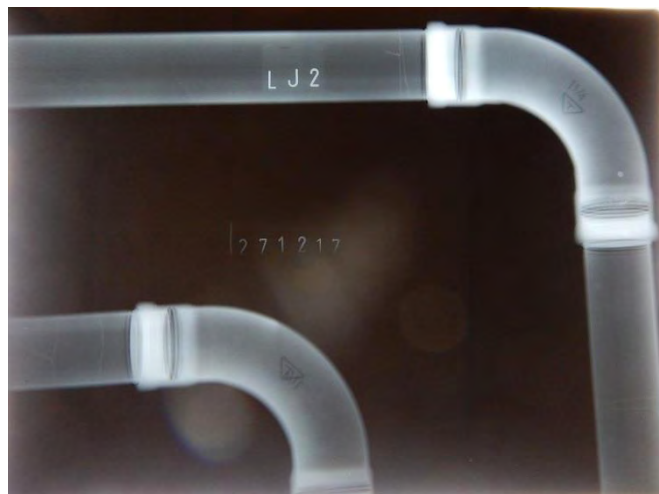
LJ2: Kuvatuilta putkiosuuksilta ei havaittu syöpymiä.
