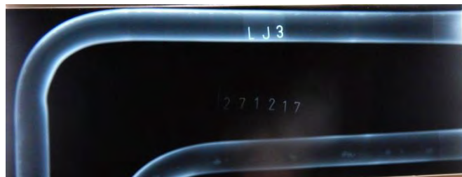
LJ3: Kuvatulta putkiosuuksilta ei havaittu syöpymiä.
